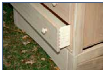
Tiroirs assemblés à queue d'aronde sur coulisses à sortie totale et fermeture automatique
